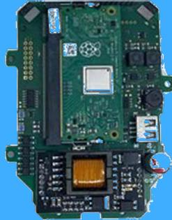
Bietet Relais zur Steuerung von Zutritt und elektrischen Schlössern. Der Extension Hub arbeitet in Kombination mit anderen Sensorberg Produkten (z. B. Access Hub Protect, Access Hub Lite) und kann nicht als eigenständiges Produkt verwendet werden.
