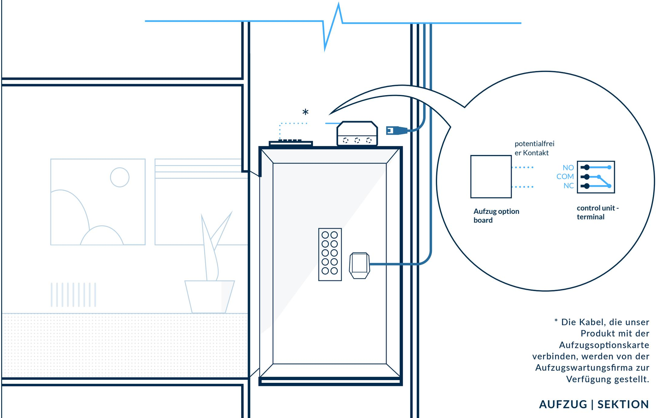
\* Die Kabel, die unser Produkt mit der Aufzugsoptionskarte verbinden, werden von der Aufzugswartungsfirma zur Verfügung gestellt.
