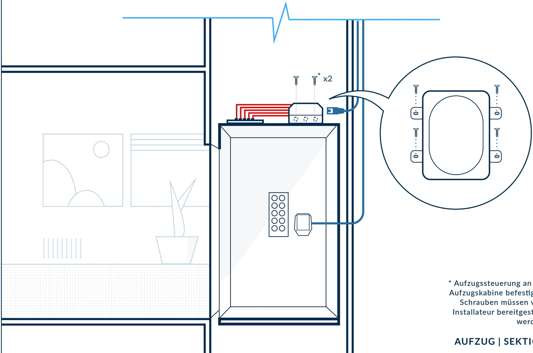
\* Aufzugssteuerung an der Aufzugskabine befestigen. Schrauben müssen vom Installateur bereitgestellt werden.
